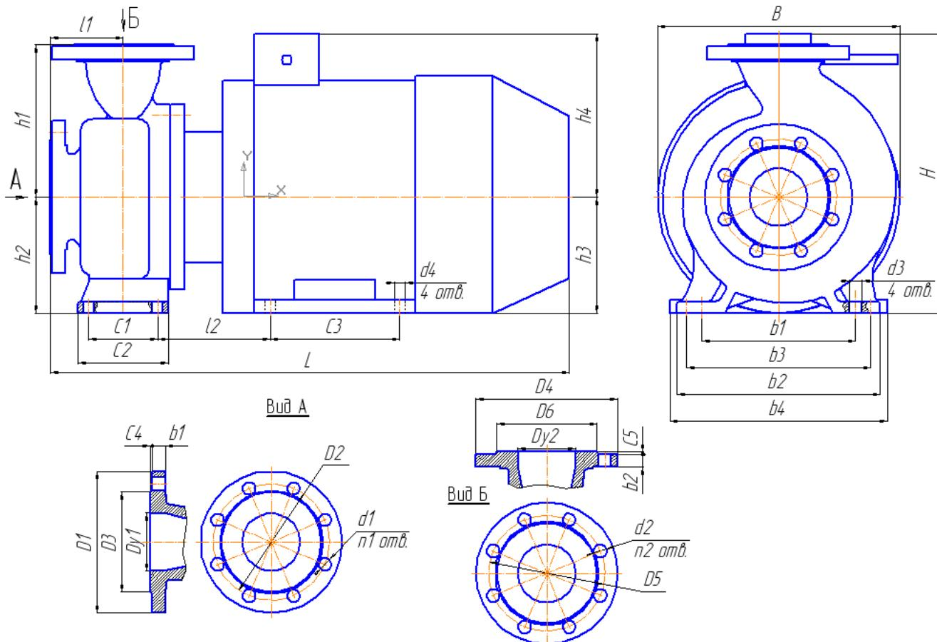
Рис. 5. Габаритные и присоединительные размеры
