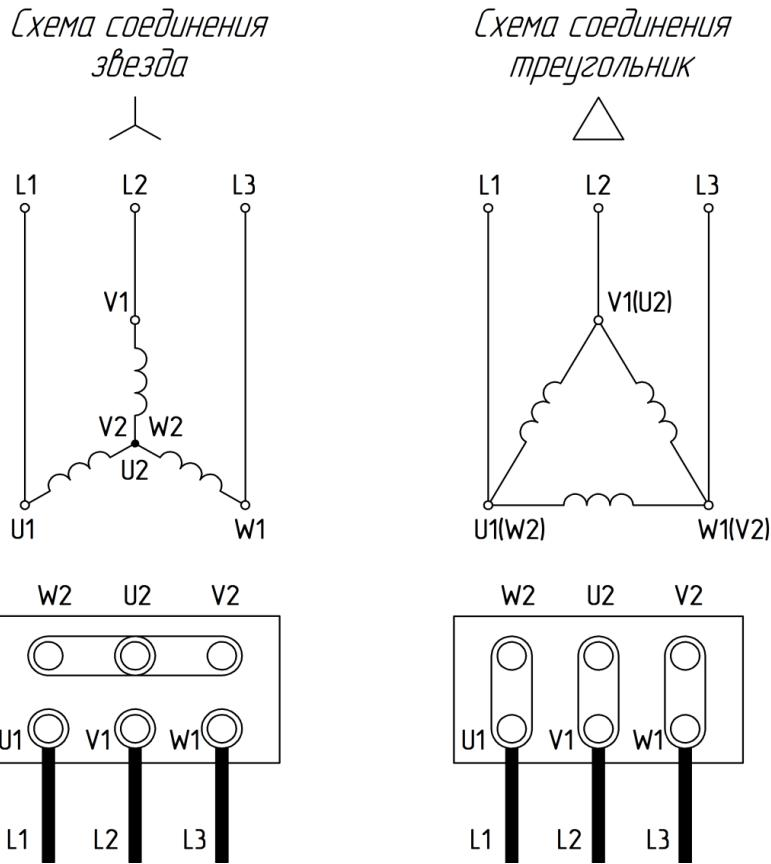
Рис. 2 Схемы подключения питания для трехфазного асинхронного двигателя
