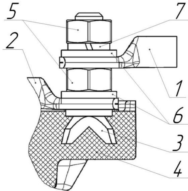
Рис. 1 Схема контактного соединения
